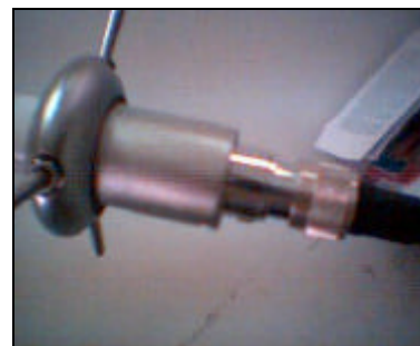
Gambar 13. Antena Omni dan Kabel Coaxial
