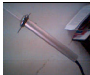
Gambar 14. Antena Omni, Kabel dan Pipa Penyangga
