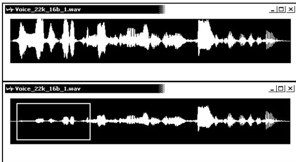
**Gambar 15. Contoh efek fade in pada file wav**
